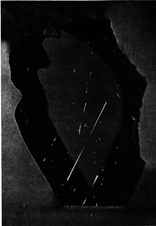
Abb. 2. EL eines kubischen ZnS:Cu-Einkristalls (mit schwacher Untergrundbeleuchtung). Länge des großen Doppelkometen 2,3 mm. Elektroden oben und unten.
